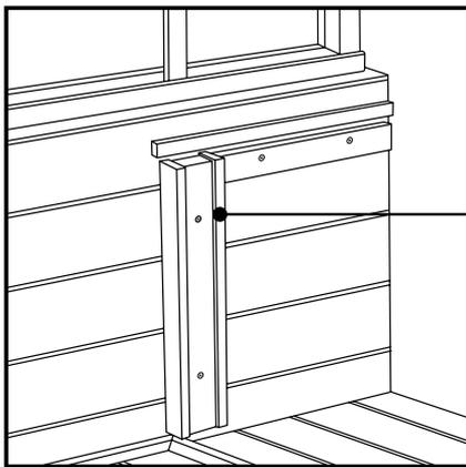
die vertikalen Führungen des Sitzbankheizkörpers befinden sich an den Seitenwänden
